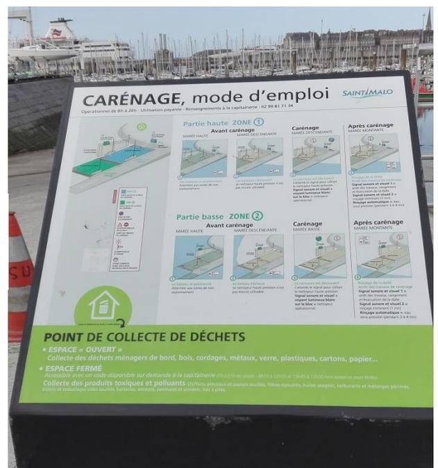
Cale submersible de grande capacité, pouvant accueillir une quinzaine de bateaux en même temps sur la cale ; 6 postes haute pression avec monnayeur. Le dispositif est réglé pour permettre un rinçage de la cle avant la remontée de la mer, temporisé au moyen d'une horloge à marée. Un signal d'alerte retentit pour avertir les usagers.
